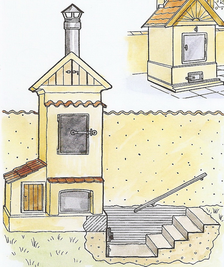
Obr. 78 Udírna postavená u zdi se schody
