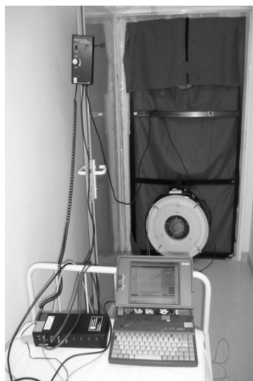
Obr. 4 – Měření celkové průvzdušnosti obálky budovy metodou tlakového spádu. Vlevo princip metody, vpravo zařízení blower door.
